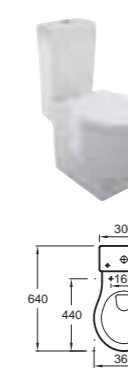
4448K Унитаз 64 x 36 см с горизонтальным выпуском, слив на 4/6 л, крышка-сиденье с механизмом «плавное опускание» E4770 Полностью оснащенный бачок с механизмом экономии воды на 2,6/4 л
